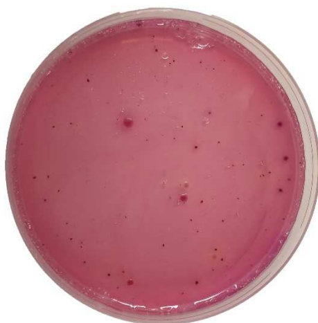
Obr. č. 2: Ukázka nárůstu kolonií koliformních bakterií na VRBL agaru
