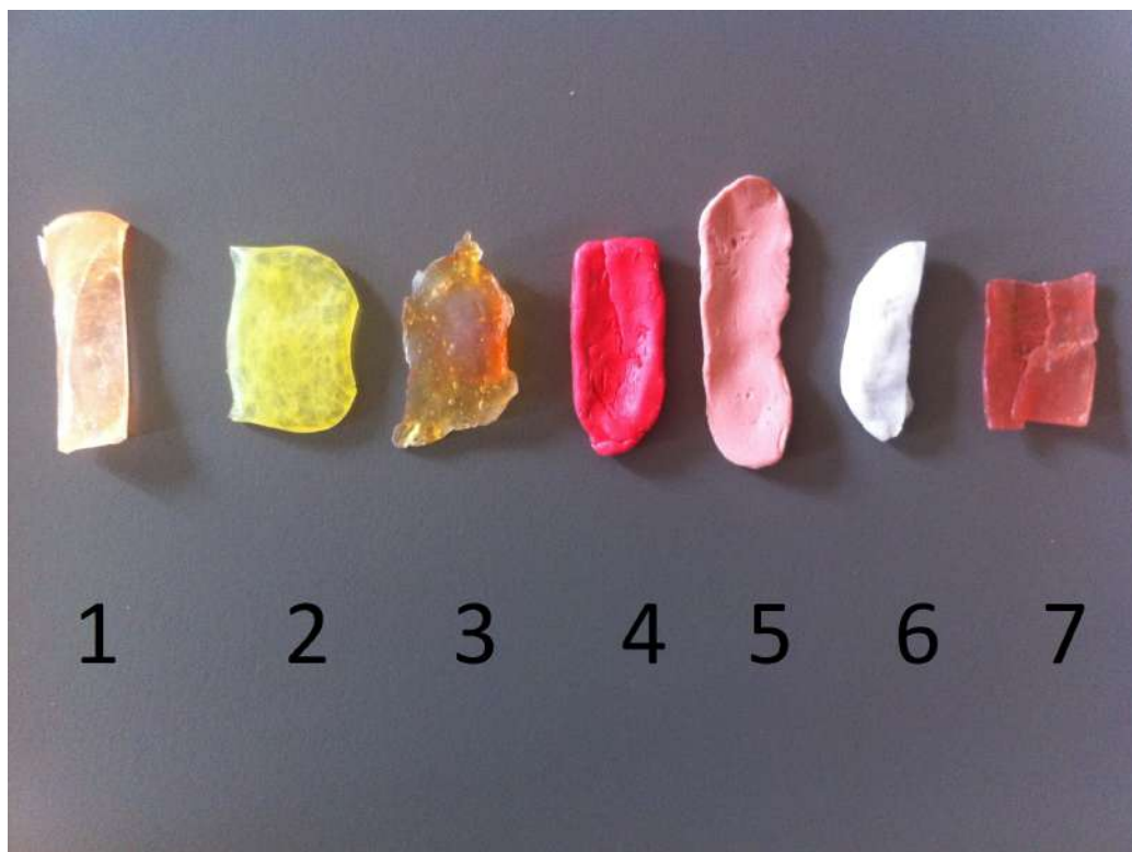
Obrázek 6.2: Použité falzifikáty pro optickou metodu
