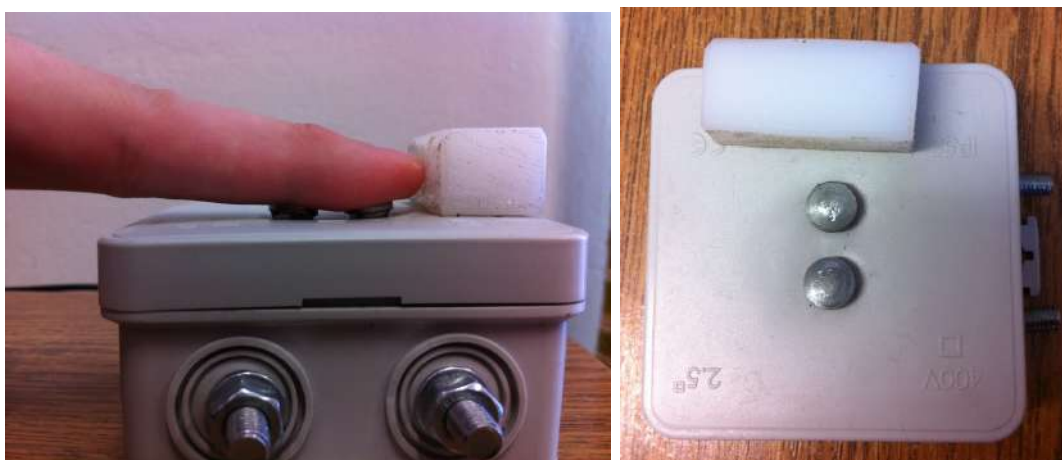
Obrázek 5.2: Přípravek pro měření odporu a kapacity prstu
