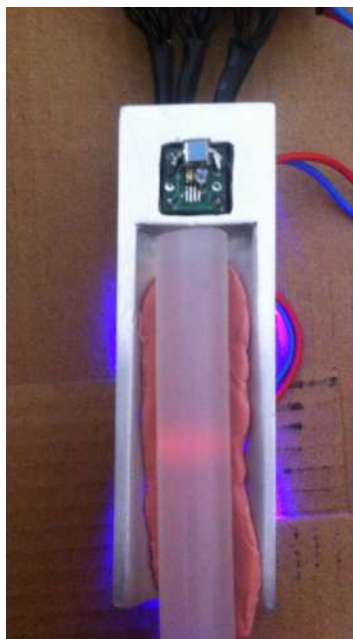
Obrázek 6.3: Ukázka vložení falzifikátu na přístroji
