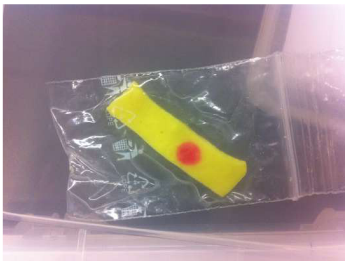
Obrázek 5.4: Detailnější ukázka falzifikátu z materiálu tropicalgin
