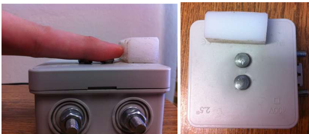
Obrázek 5.2: Přípravek pro měření odporu a kapacity prstu
