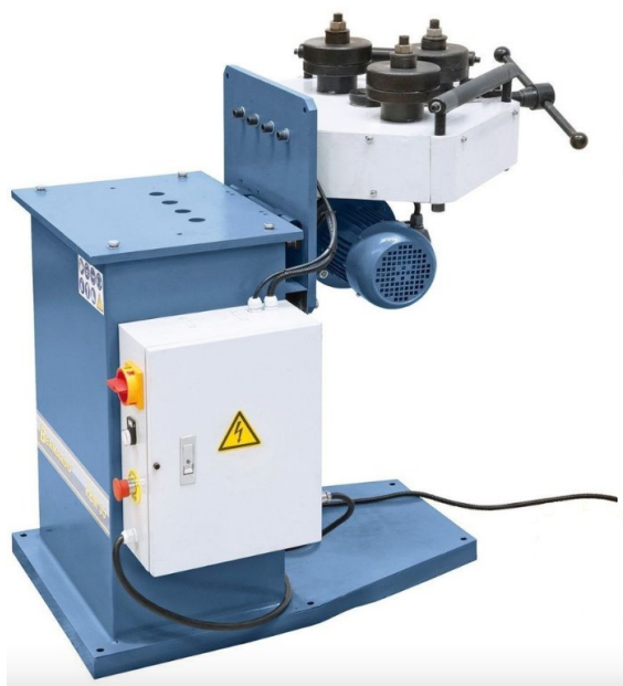
Obr. 3.2 Univerzálně použitelná zakružovačka profilů
