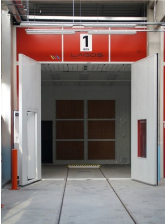
Obr. 3.7 Lakovací kabina syntetického nátěru LAGOS
