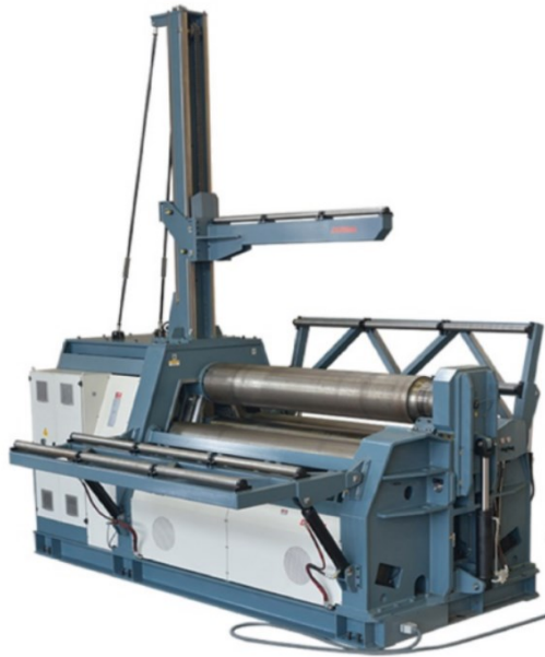
Obr. 3.3 Zakružovačka plechů HRB-4
