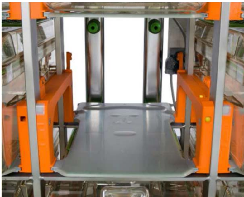
Obrázek 1.6: Pozice pro chovnou nádobu v DVC stojanu s deskou na monitoring aktivity zvířat a vlhkosti podestýlky a postranními elektrodami (zdroj Tecniplast S.p.A).
