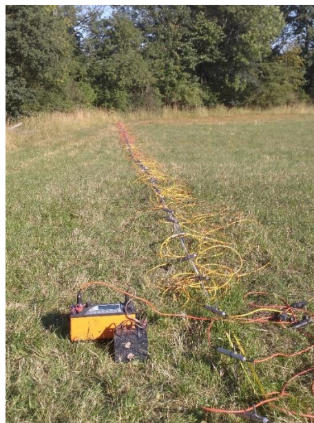
Obr.28. a) řídicí jednotka ARES připojená k externímu zdroji b) měření profilu odporovou tomografií (foto 3.7.2018)
