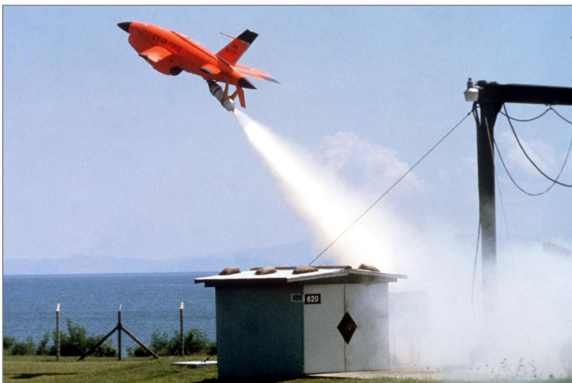
Obr. 2.3 Vzlet bezpilotného systému Firebee (model BQM-34A), USA [17]
