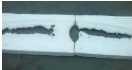
Obr. 1.14 Pohled na polykarbonátový světlík [4] Obr. 1.15 Vypálení EPS slun. zářením [4]
