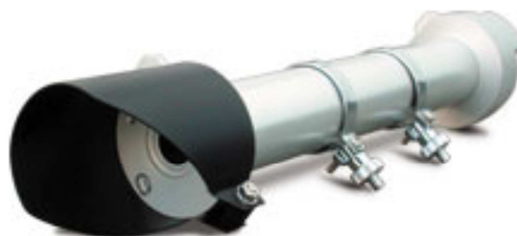
Obr. 4.19 Pyrheliometr (měření přímého záření) [27]
