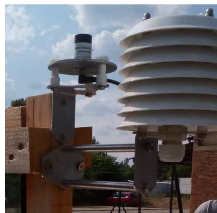
Obr. 8.8 radiační kryt AI077 a a pyrometr EMS 11
