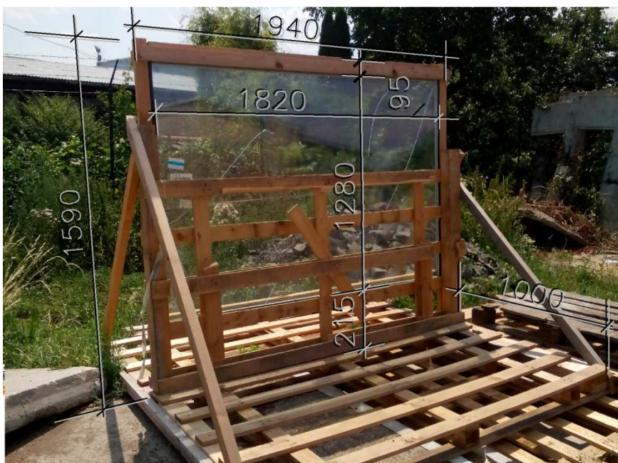
Obr. 8.3 Dřevěný skelet experimentálního modelu
