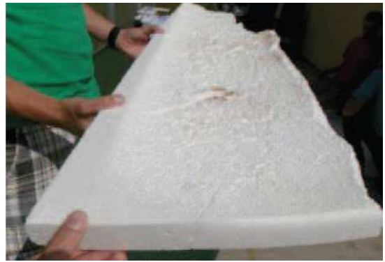
Obr.1.10 Pohled na jihojihozápadní fasádu [4] Obr. 1.11 Deformace tvaru EPS [4]
