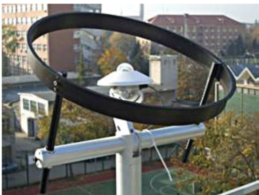
Obr. 4.18 Měření difúzní složky záření pomocí kruhové clony [26]
