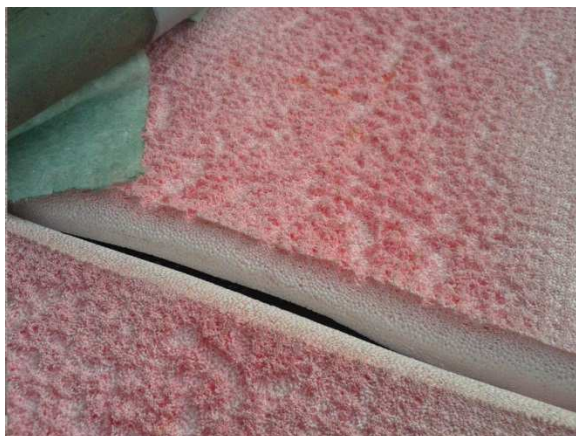
Obr. 1.9 Detail povrchové degradace EPS [4]
