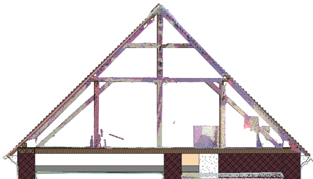
Obr. 69 Prohnutí krokví konstrukce vyplývající z porovnání mračna bodů a modelu v řezu
