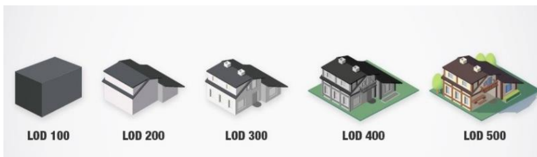
Obr. 1 Schematické znázornění obsahu jednotlivých LOD [6]
