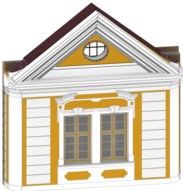
Obr. 61 Vymodelovaný atikový štít trojúhelníkového tvaru
