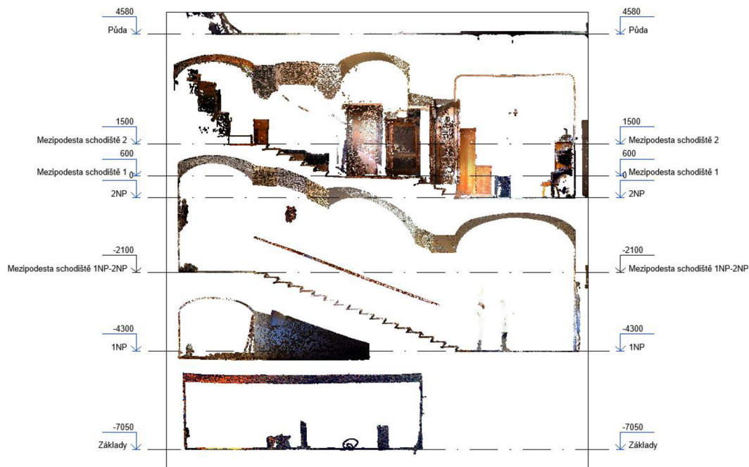
Obr. 14 Prvotní nastavení výškových úrovní dle mračna bodů
