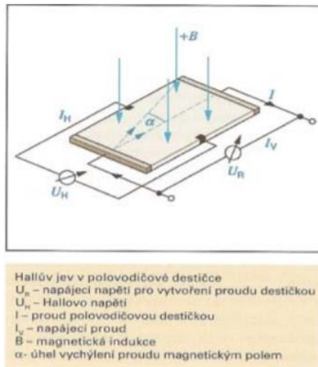
Obr. 17 - Hallův snímač [26]
