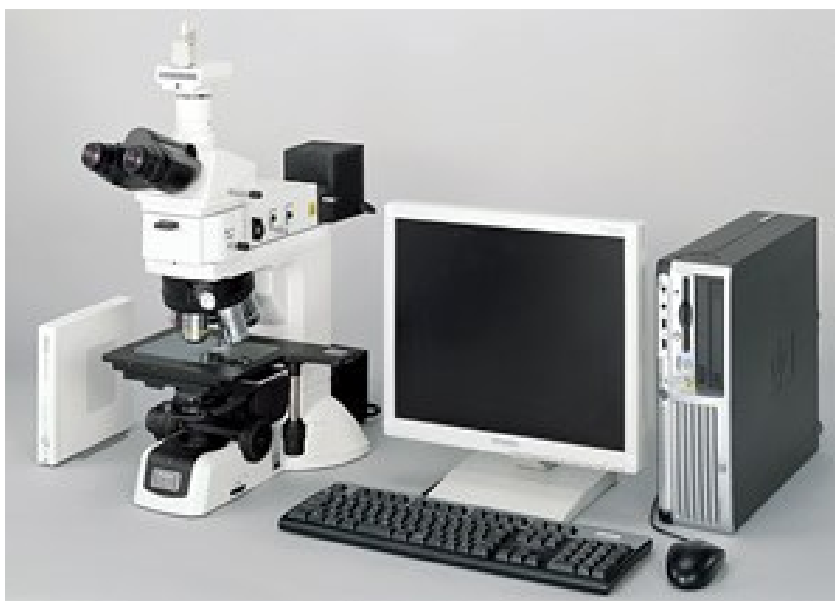
Obr. 21 Sestava pro počítačovou analýzu obrazu se softwarem NIS Elements
