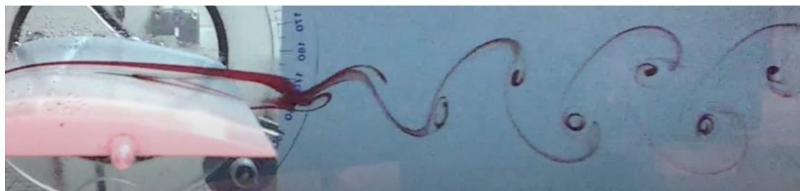
Obr. 4.23 Stezka při obtékání aerodynamického profilu s nulovým úhlem náběhu [16].
