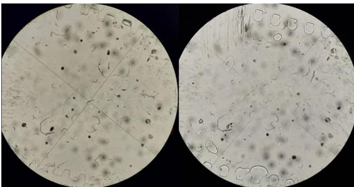
Obrázek 8: Kanálek o šířce 300 \mu\text{m} (vlevo – naplněný roztokem PBS; vpravo – s membránami)
