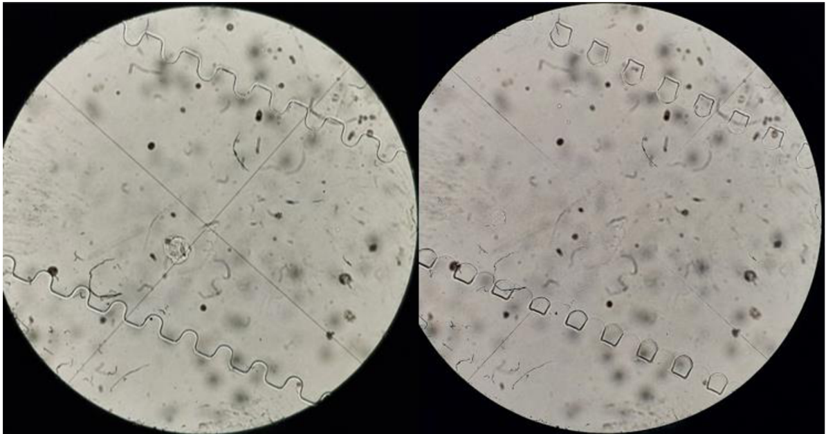
Obrázek 9: Kanálky o šířce 200 µm (vlevo – naplněný roztokem PBS; vpravo – s membránami)
