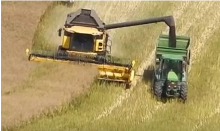
Obrázek 32 - Nedostatečné využití záběru při vyprazdňování zásobníku zrna
