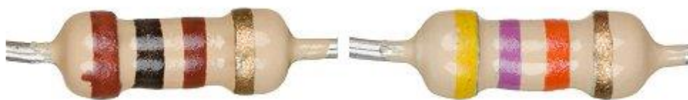
Obrázek 6 Rezistory. Barevné proužky na rezistorech označují hodnotu jejich odporu.
