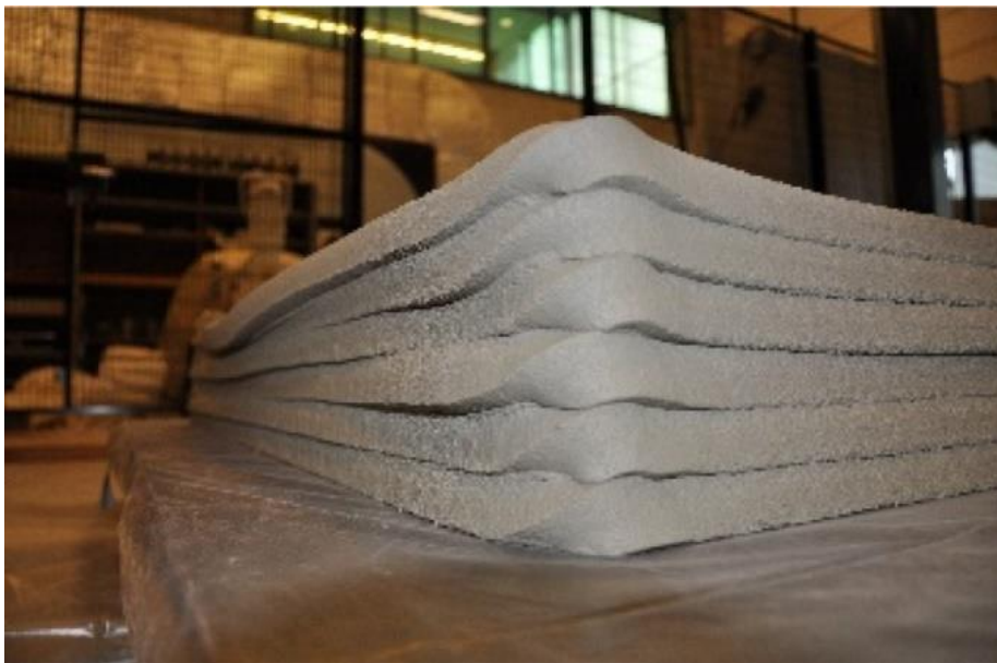
Obrázek 10: Kroucení cementového filamentu bez využití otočné trysky [20]
