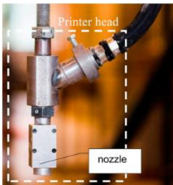
Obrázek 8: Pasivní tisková hlavice s tryskou. V pravé části je přírodní dávkovací hadice [20]
