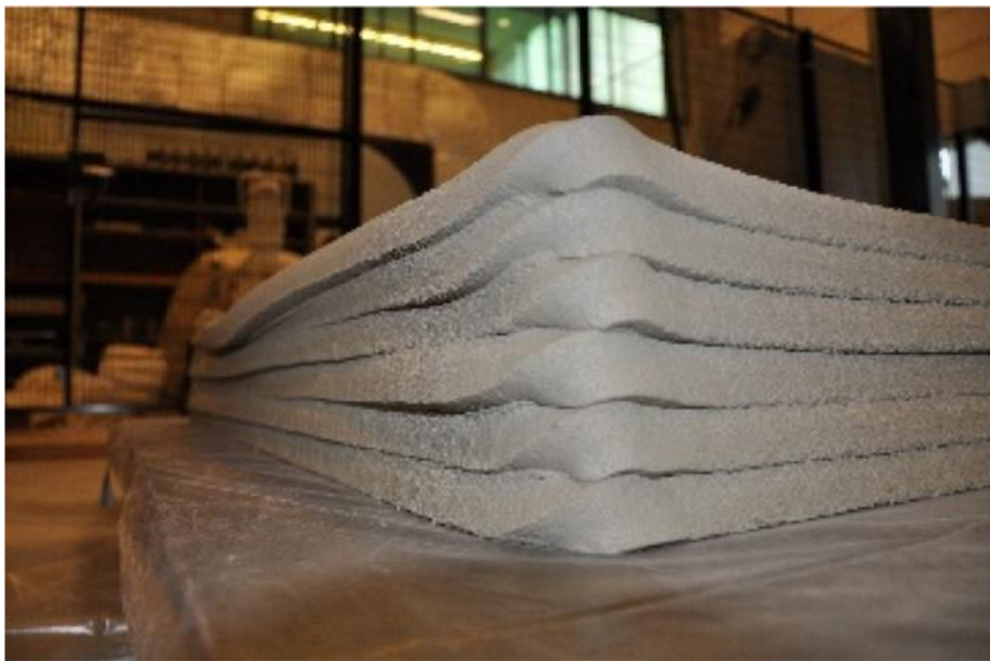
Obrázek 10: Kroucení cementového filamentu bez využití otočné trysky [20]
