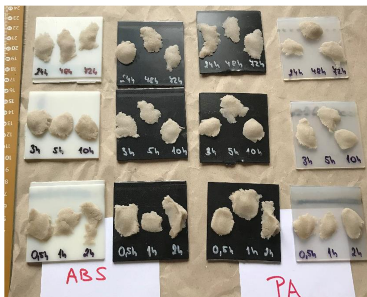
Obrázek 12: Ukázka experimentu přilnavosti směsi k materiálu
