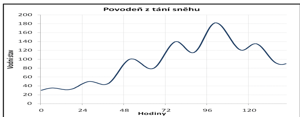
Obr. č. 1: Typický průběh povodně při povodni z tání sněhu (ČHMÚ, nevedeno)
