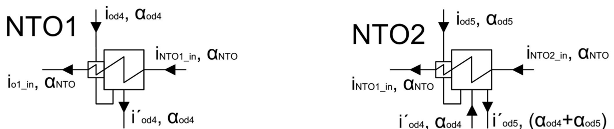
Obrázek 16 – Bilanční schéma NTO1 a NTO2 ohříváků
