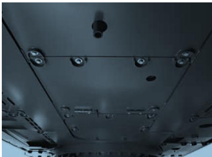
Obrázek 14 – Ochranné plátování podvozku
