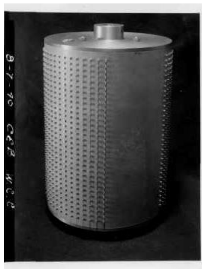
Obr.28 Buben tvořící vnitřní paměť počítače ABC. Zdroj: [49]
