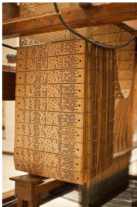
Obr. 16 Děrný štítek jako program na tkalcovském stavu. Zdroj: [39]
