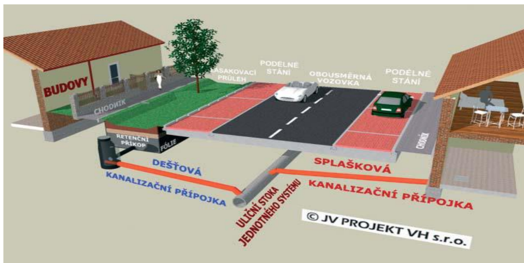
Obrázek 19: Příklad dispozičního uspořádání ulice s decentralizovaným odvodněním
