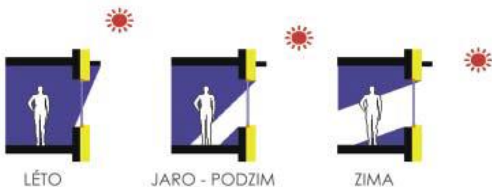
Obrázek 6 : Správné funkční umístění oken
