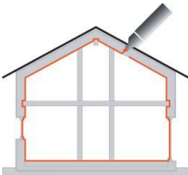
Obrázek 7 : Zobrazení těsnosti obálky domu v řezu
