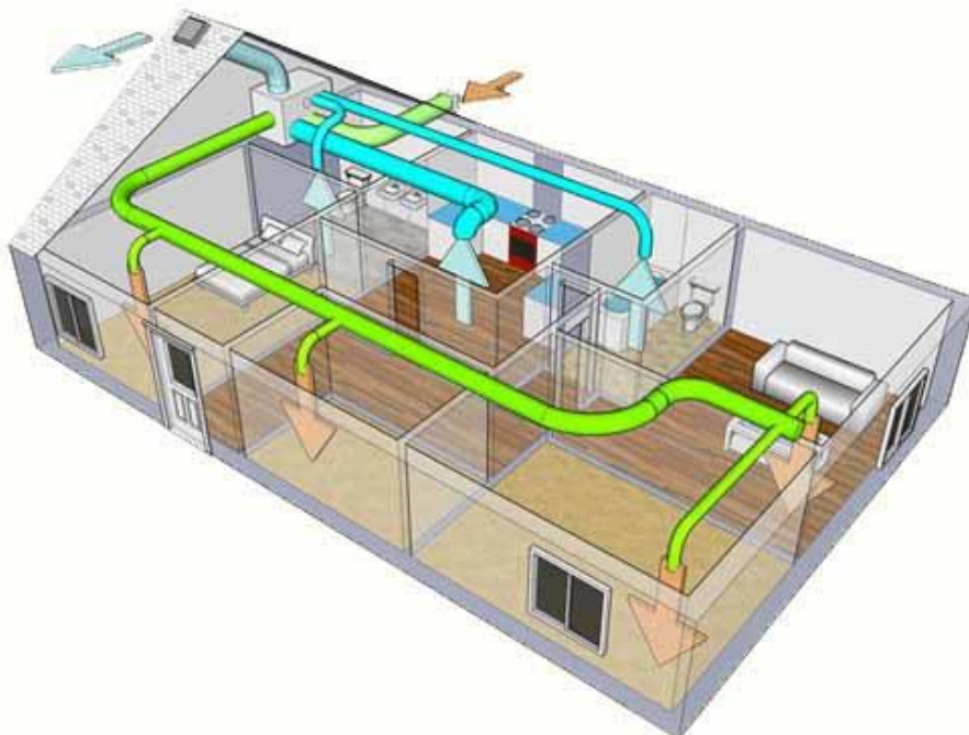
Obrázek 34 : Centrální systém větrání
