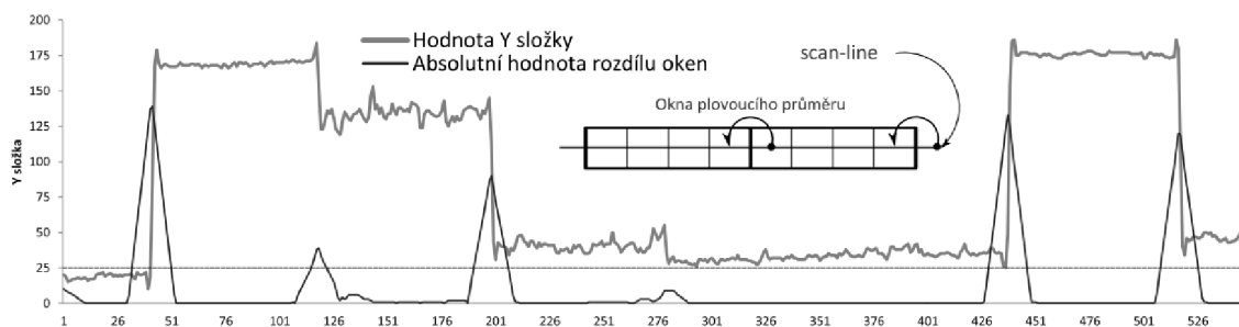
Obrázek 4.5: Hledání hran pomocí 2 oken s plovoucím průměrem [24].
