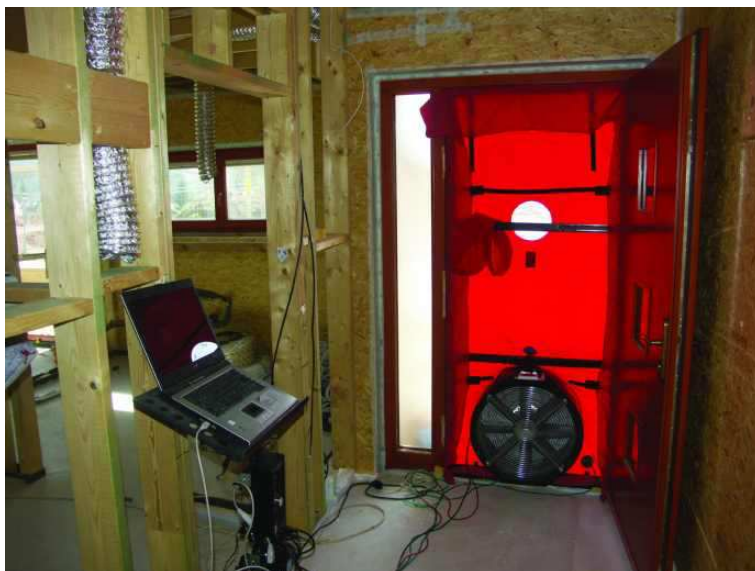
Obr. č. 23: Aparatura Blower Door testu (20).
