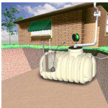
Obr.č. 38: Zásobník dešťové vody umístěný pod zemí (31).
