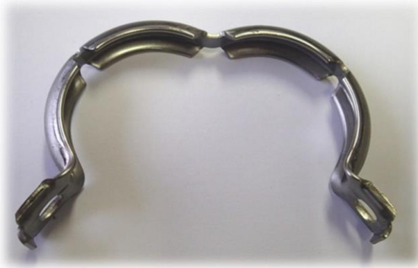
Obr. 3.5 Spona VPP 50 po vystřížení otvorů.
