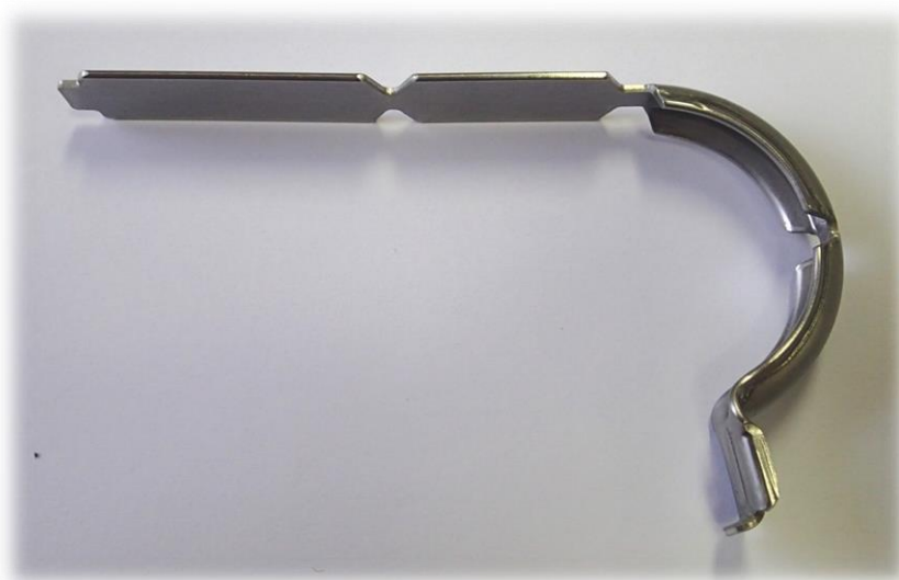
Obr. 3.3 Spona VPP 50 po 1. tvarování.
