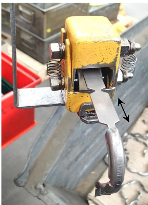
Obr. 5.2 Způsob nanášení maziva.
