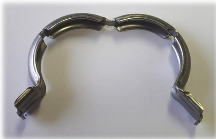
Obr. 3.4 Spona VPP 50 po 2. tvarování.
