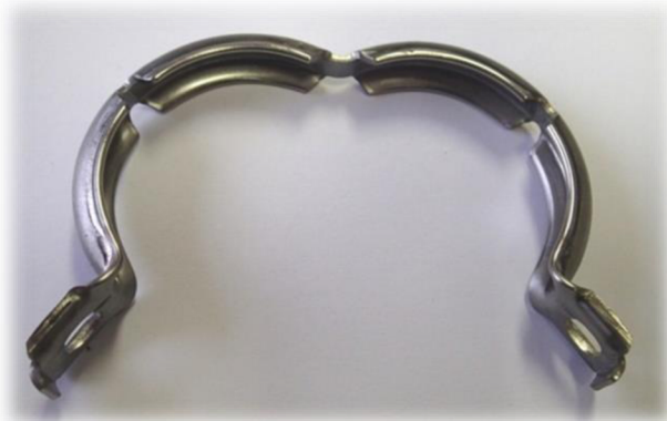
Obr. 3.5 Spona VPP 50 po vystřížení otvorů.
