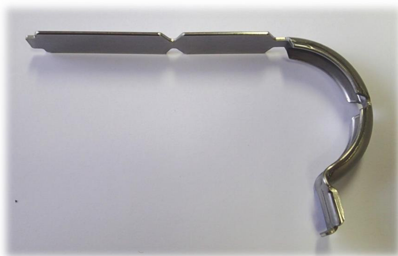
Obr. 3.3 Spona VPP 50 po 1. tvarování.
