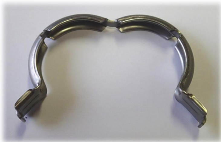
Obr. 3.4 Spona VPP 50 po 2. tvarování.
