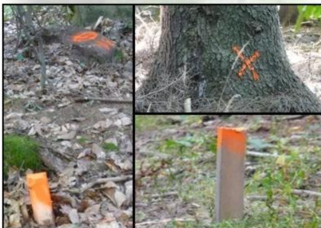
obrázek č.2 - stabilizace a zaměření bodu
