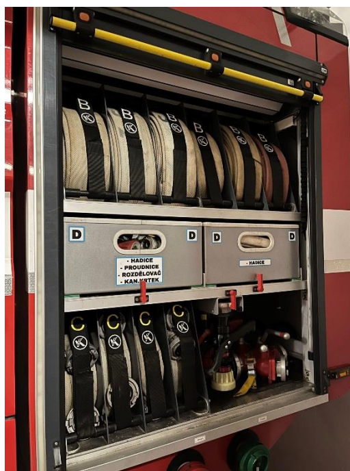
Prostor pro příslušenství na technické zásahy (vlevo). Prostor pro požární hadice, proudnice, rozdělovač apod. (vpravo).
