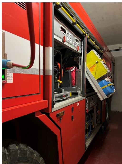
Izolační dýchací přístroje na výsuvném mechanismu a prostor pro chemické vybavení (vlevo). Vybavení pro technické zásahy (vpravo).
