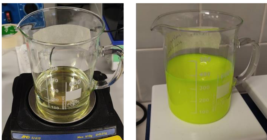
Obr. 4-11 Proces obarvení oleje pomocí fluorescenčního barviva Coumarin 6
