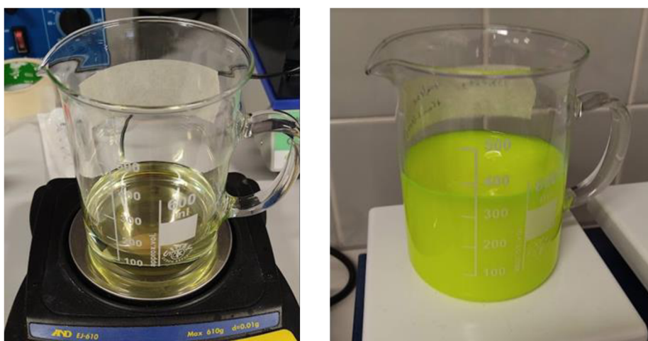
Obr. 4-11 Proces obarvení oleje pomocí fluorescenčního barviva Coumarin 6
