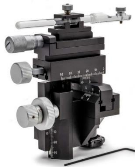
Obrázek 1.1 Ukázka mikromanipulátoru s mikroposuvy [4]
