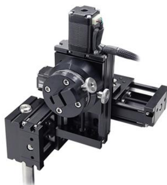
Obrázek 1.8 Ukázka piezoelektrického mikromanipulátoru [15]
