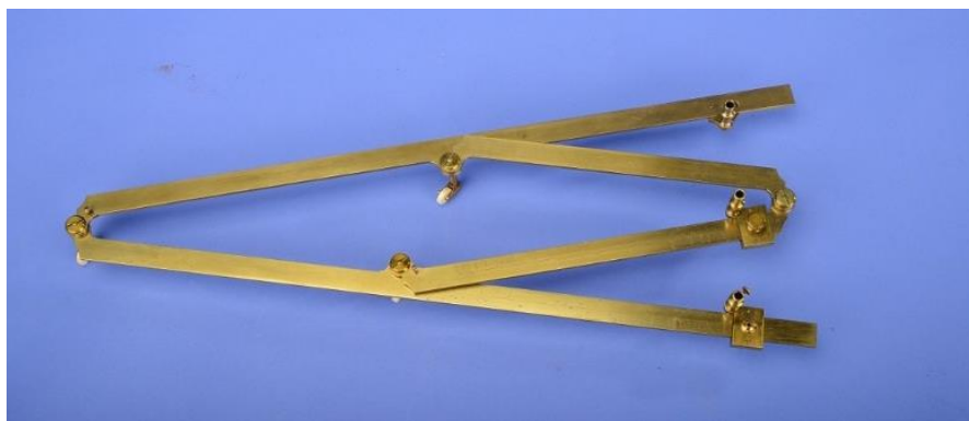
Obrázek 1.2 Ukázka pantografického mechanismu [7]
