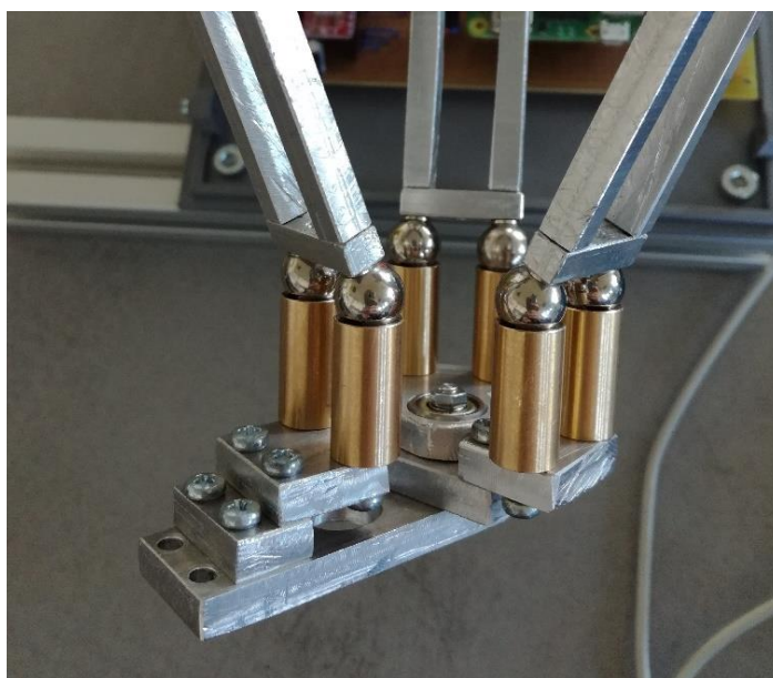
Obrázek 3.15 Ukázka vyrobené platformy pro spojení ramen
