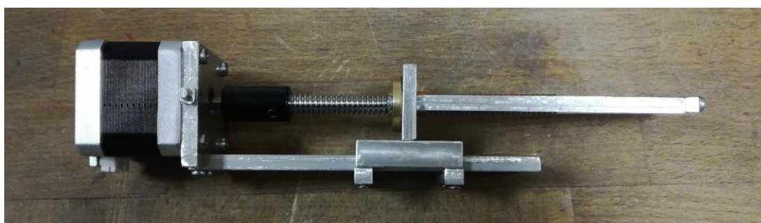
Obrázek 3.11 Ukázka ramene s novým jezdcem
