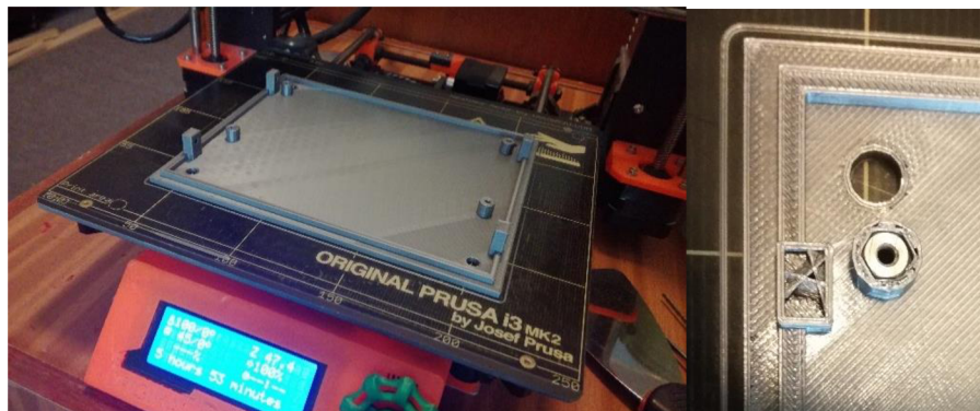
Obrázek 3.21 Ukázka procesu vkládání matic a hotového dna krabičky pro desku plošných spojů
