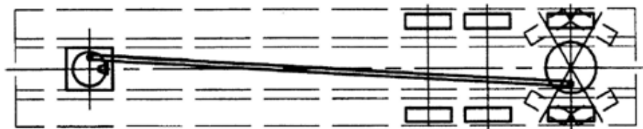
Obr. 5: Tyčové řízení poslední nápravy návěsu (Schmitz) [16]
