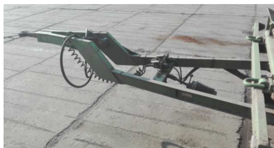
Obr. 11: Oj přívěsu s točnicí s nastavením výšky oje při rozpojení
