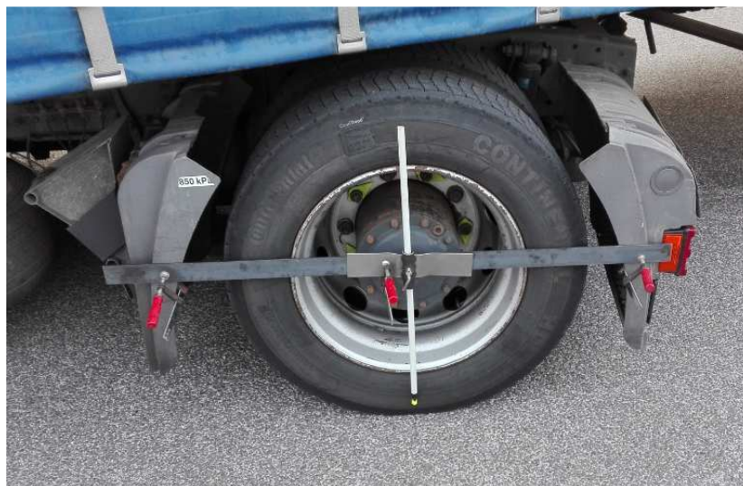
Obr. 18: Připevnění značkovacího zařízení na zadním levém kole tahače návěsu
