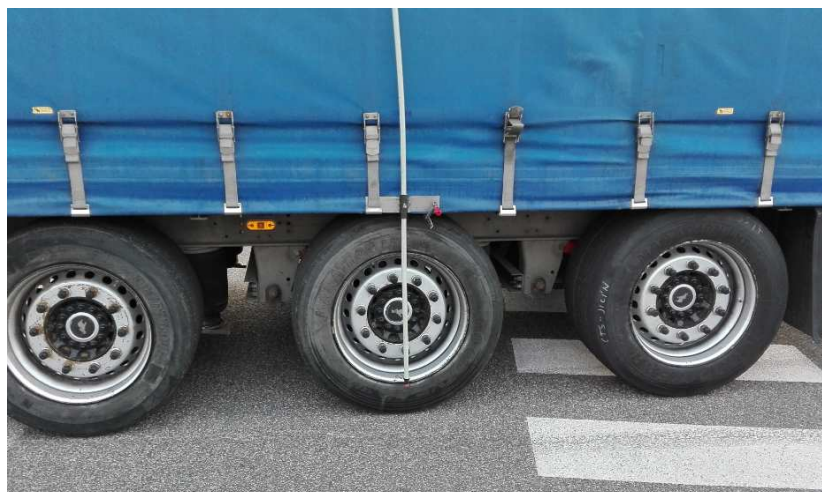
Obr. 18: Připevnění značkovacího zařízení na zadním levém kole tahače návěsu
