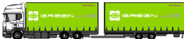
Obr. 27: Jumbo souprava 120\text{ m}^3 , rozměr ložné plochy 7,3\text{ m} + 8,2\text{ m} \times 2,48\text{ m} \times 3\text{ m} [21]
