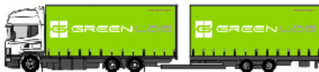
Obr. 28: Jumbo souprava 120 m 3 , rozměr ložné plochy 7,7 m + 7,7 m x 2,48 m x 3 m [21]
