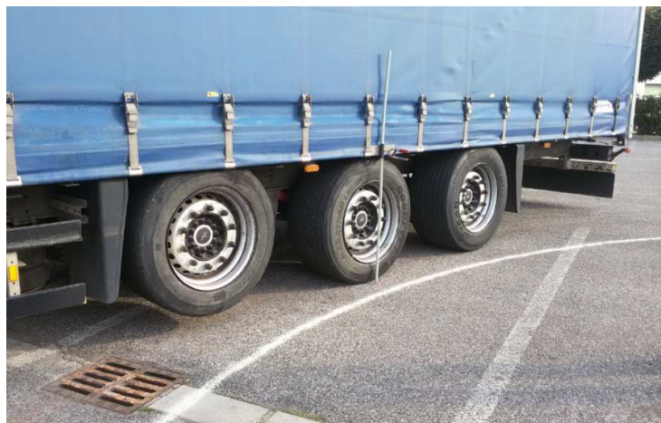
Obr. 22: Měření návěsové soupravy se zvednutou přední nápravou u návěsu
