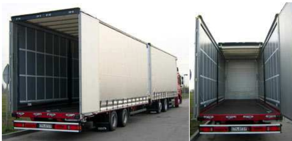
Obr. 9: Tandemová souprava s průjezdnými vraty – průhled přívěsem až k čelu ložného prostoru motorového vozidla [10]
