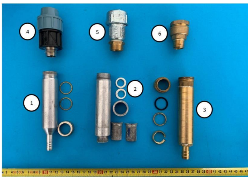
Obrázek 20 Nástavce k uchycení membránového svazku (1 – první design, 2 – druhý design, 3 – třetí design, 4–6 – příklady komerčně dostupných spojek z různých materiálů)
