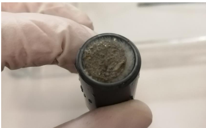
Obrázek 26 Nečistoty nahromaděné na vstupu do svazku
