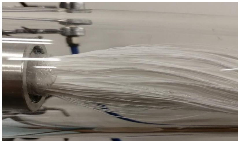
Obrázek 28 Kapičky na povrchu vláken
