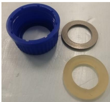
Obrázek 19 Systém uchycení nástavce v závitu GL45
