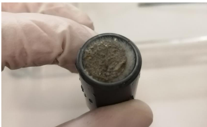
Obrázek 26 Nečistoty nahromaděné na vstupu do svazku
