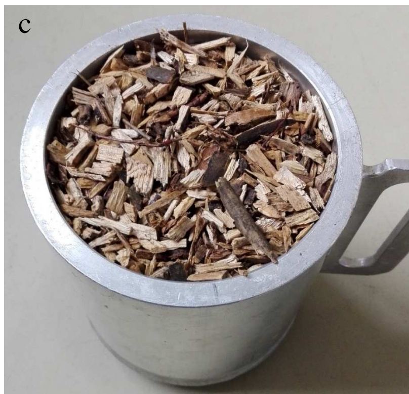
Obr. 3.9: Frakce reálné dřevní štěpky v měřící komoře aparatury pro měření objemu partikulárních částic
