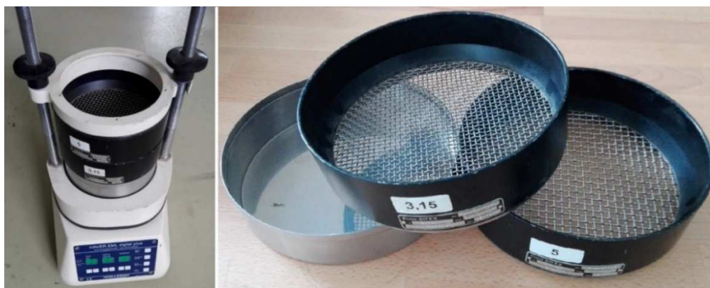
Obr. 3.6: Vibrační síťový analyzátor a síta o velikosti ok 5 mm a 3,15 mm
