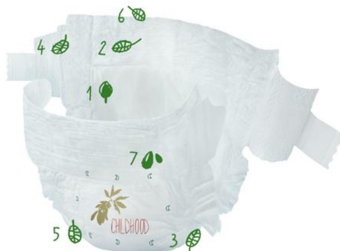
Obrázek 13: Jednorázová ekoplenka Naty 1 – absorpční jádro s buničinou, 2 – vrchní potah, 3 – vnější vrstva, 4 – přípeňovací poutka, 5 – vrstva zabraňující prosakování, 6 – tkanina obalující absorpční jádro, 7 – potisk[29]
