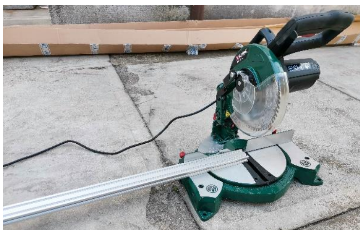
Obr. 30 Postup řezání hliníkových profilů pomocí pokosové pily.
