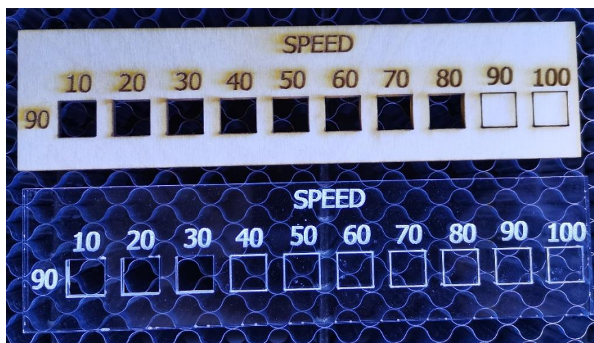
Obr. 72 Testovací destičky z MDF březové desky a PMMA.
