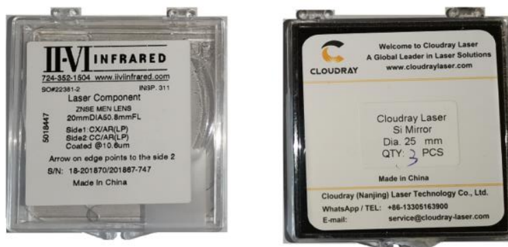
Obr. 17 Si zrcadla s poloměrem 25 mm a ZnSe čočka s ohniskovou vzdáleností 50,8 mm a poloměrem 20 mm.
