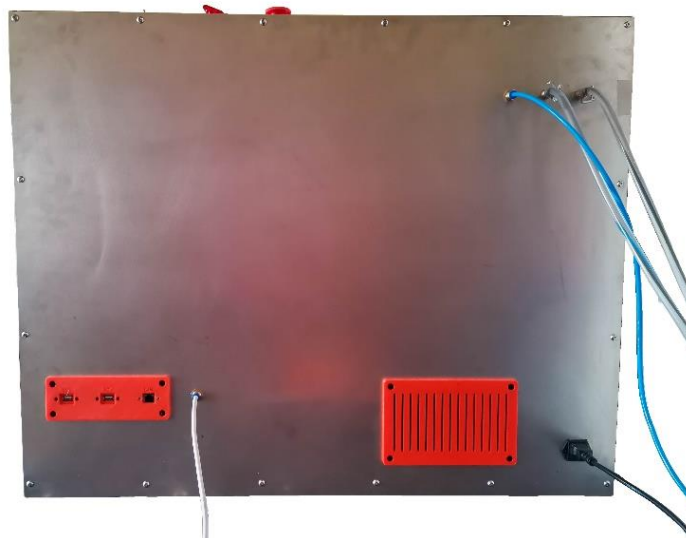
Obr. 38 Pravá bočnice s mřížkou pro přívod vzduchu a panelem pro zapojení externího paměťového zařízení a ethernetového kabelu.
