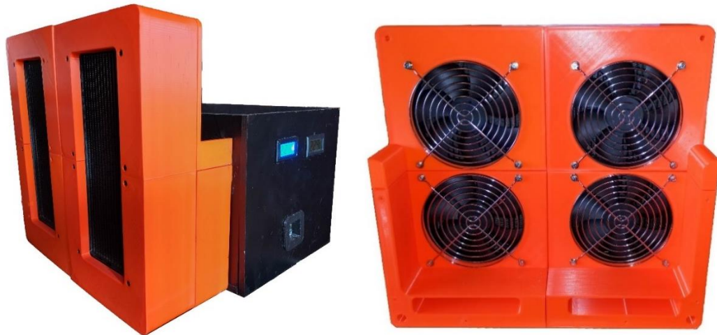
Obr. 58 Vyrobené prototypové vodní chlazení.
