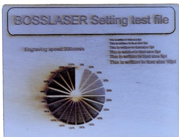
Obr. 78 Testování výkonu pro gravírování při rychlosti 300 \text{ mm} \cdot \text{s}^{-1} .
