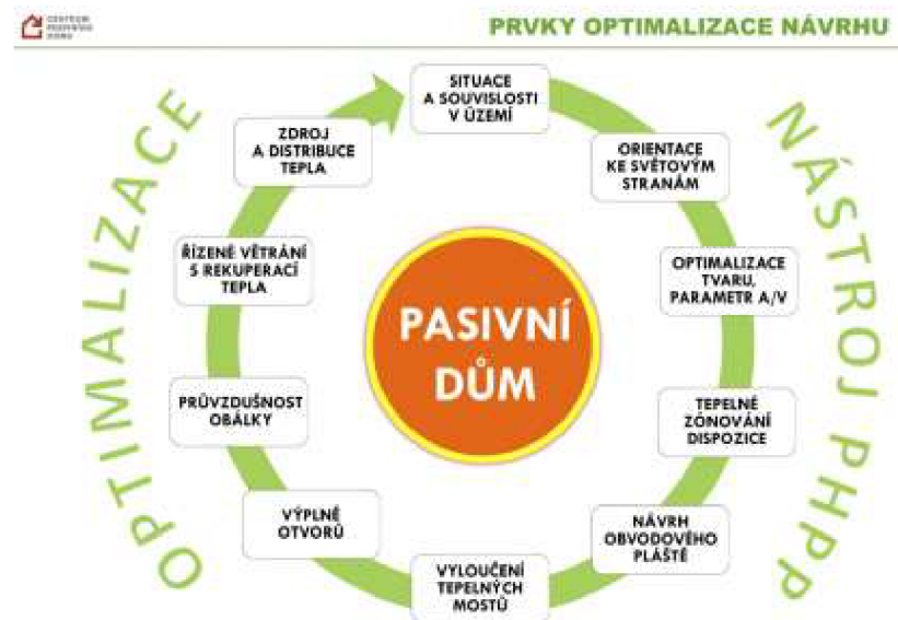
Obrázek 5 – Optimalizace návrhu pasivního domu (zdroj: [20])
