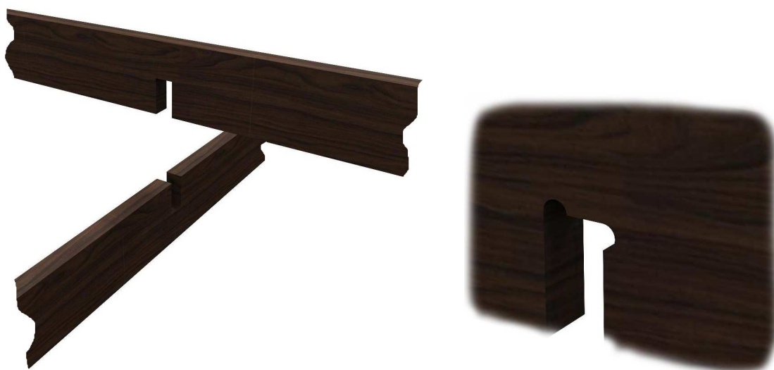
Obrázek 42. Spoj přeplátováním [autor práce]
