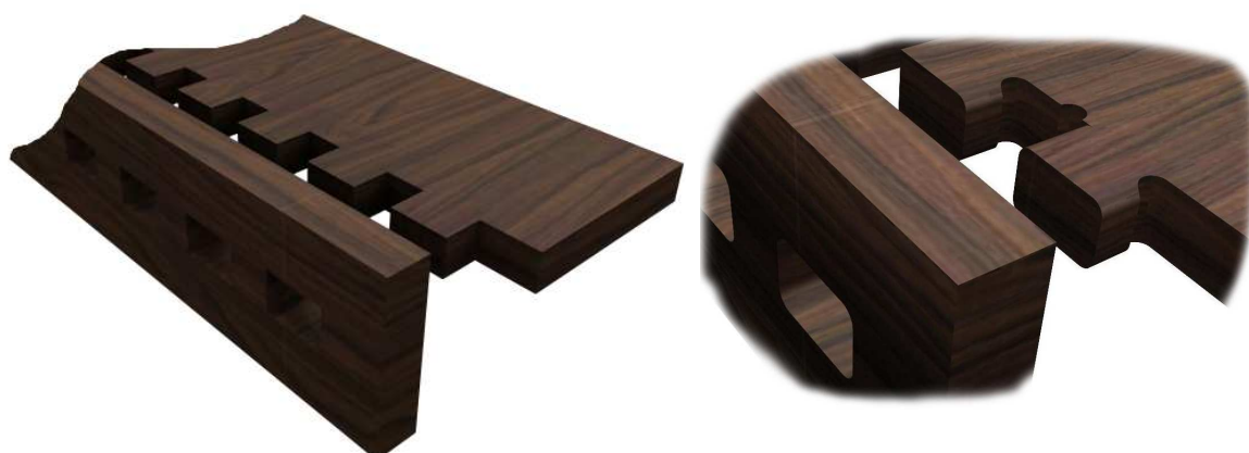
Obrázek 44. Spoj za pomoci uzavřených čepů [autor práce]
