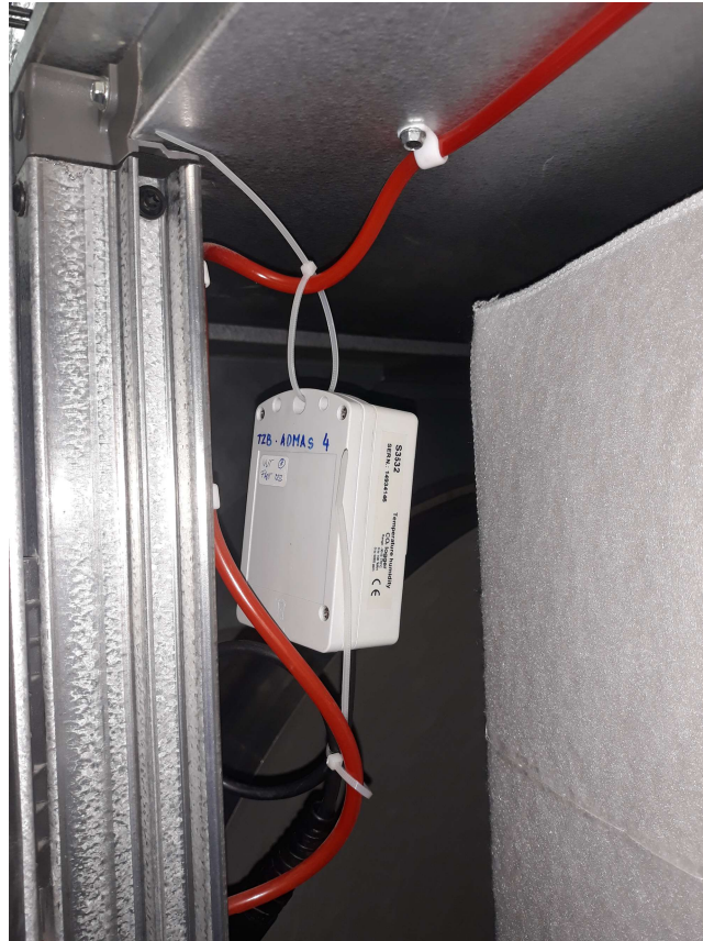
Obrázek 66 – Datalogger Comet se sondou CO2 v odvodním kapsovém filtru
