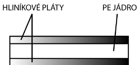
Obr. 19 Struktura sendvičové desky
