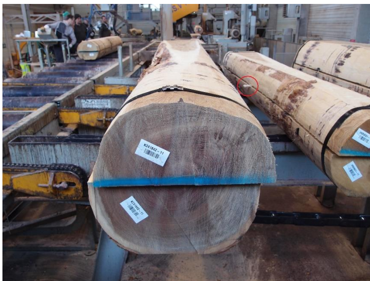
Obrázek 10: Výřezy zapáskované metodou lat' uprostřed. Na výřezu vpravo, v červeném kolečku, je patrná lat' umístěná kolmo na podélnou osu kmene.
