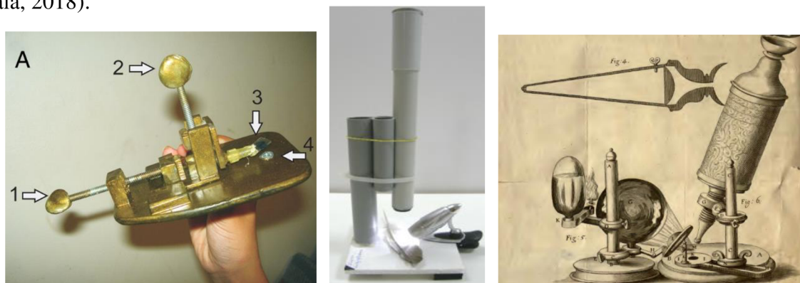
Obr. 6-8: Replika Leeuwenhoekova mikroskopu. 1 šroub pro pohyb stolku, 2 zaostřovací šroub, 3 podložní sklíčko s preparátem, 4 čočka (zdroj: Sepel et al., 2009, s. 340). Replika Hookeova mikroskopu (zdroj: Tsagliotis, 2010, s. 215). Skutečný mikroskop sestavený Robertem Hookem (zdroj: Hooke, 1665, příl. 1)
