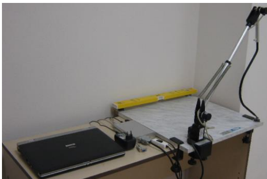
Obrázek 5. Součásti DTP-2: polohový snímač, základní deska, elektronická vyhodnocovací jednotka, osobní počítač (fotoarchiv autorky, 2014)
