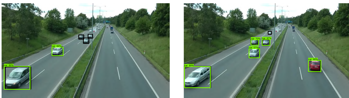
(a) Výsledek testovací sady na modelu SSD Inception V2, kde jsou vidět tři nedetekovaná vozidla.
