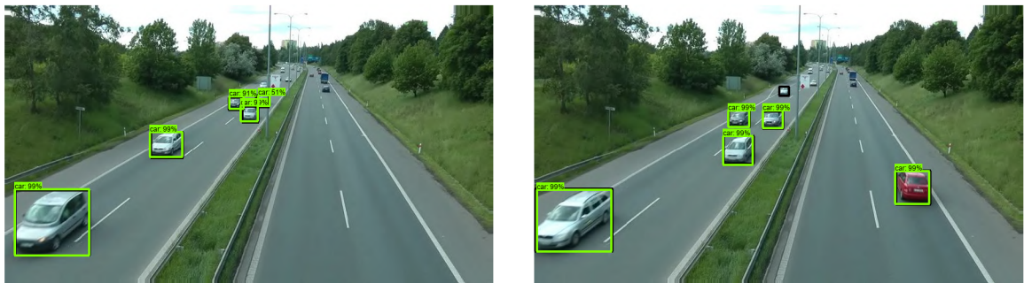
(a) Výsledek testovací sady na modelu Faster R-CNN, kde model detekoval všechny projíždějící vozidla.
