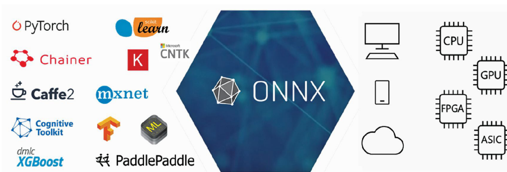
Obrázek 3.2: Onnx sprostředkovává rozhraní a formát modelů, které je možné použít ve více frameworkích, a také je možné je spouštět na několika možných zařízeních. [22].
