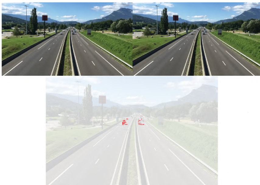
Obrázek 4.10: Snímky z videa pro diferenci. Video běží v 30 snímcích za sekundu, to znamená, že časový rozdíl snímků je 33ms.
