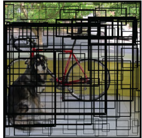
(b) Vstupní obrázek, s ohraničeními, kde tloušťka čáry odpovídá pravděpodobnosti, že se vevnitř nachází objekt. Čím tlustší čára, tím větší pravděpodobnost [10].
