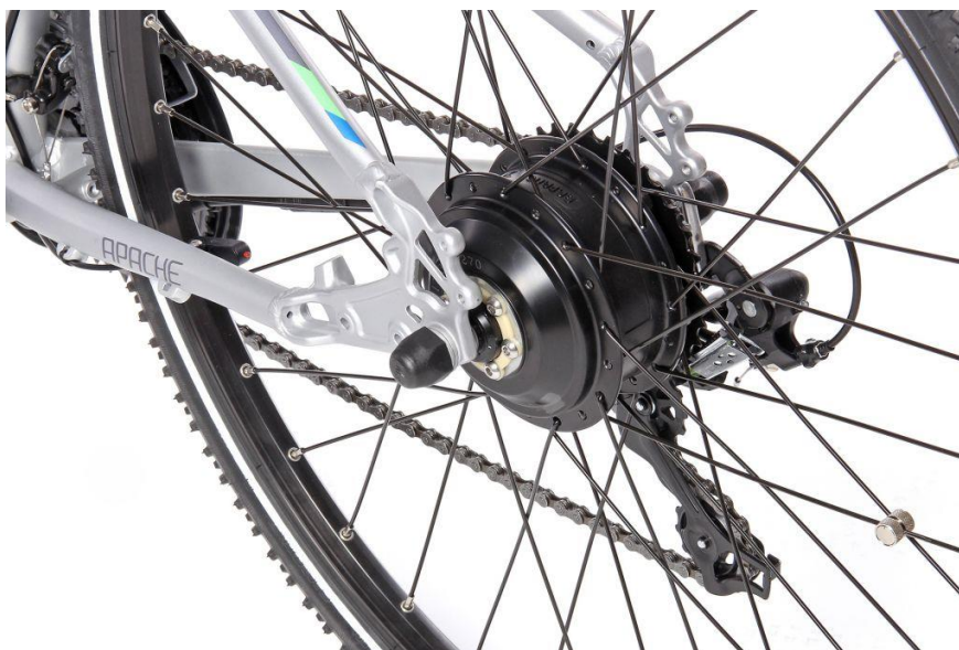
Obr. 24 Motor v náboji zadního kola [37]
