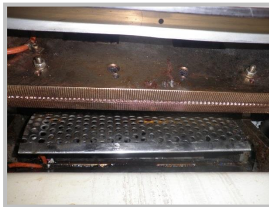
Obr. 28.: Sekací nůž – po vyčištění
